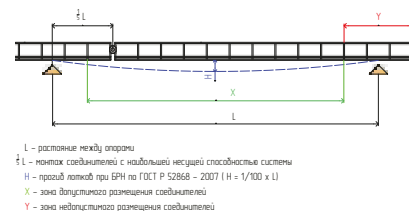
Размещение креплений
